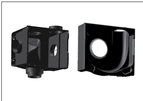
Fig. 14 Aanzuigplenum met slakkenhuis en inlaatring
